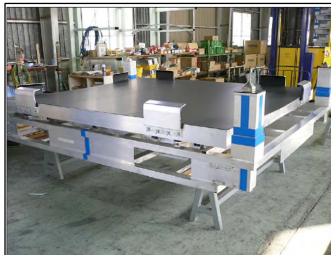
使用自攻螺絲自行組立的架台治具
