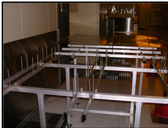
使用焊接螺絲來進行組裝的鋁擠型骨架
